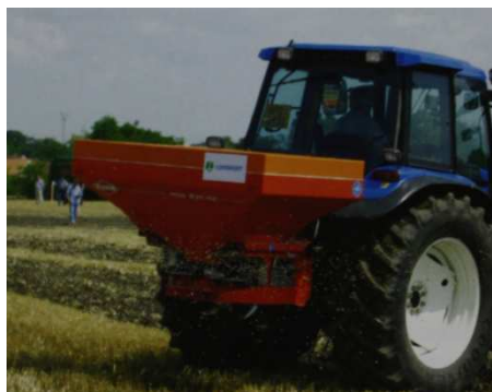
Obr. 4. Kotúčový rozhadzovač priemyselných hnojív (Javorek, 2008).
