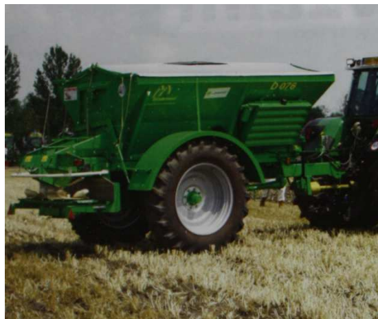
Obr. 7. Závesný rozhadzovač priemyselných hnojív (Javorek, 2008).
