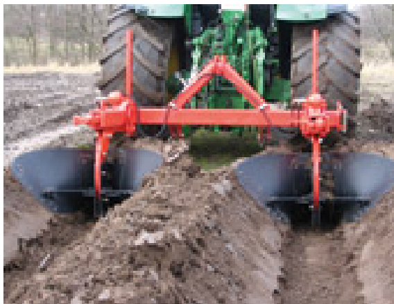
Obr.2 : Tvarovač ( ryhovač) záhonov GH 200
