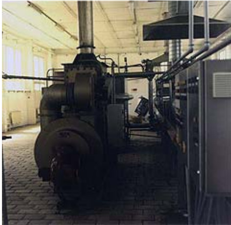
Obr. 14 : Pec na vyprážanie lupienkov
