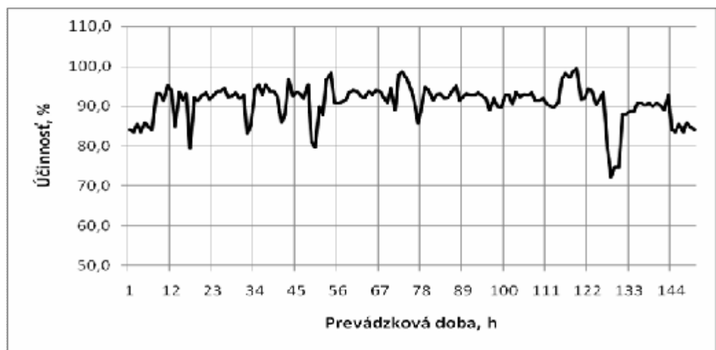
Obr. 60 Zmena účinnosti využitia tepelnej energie pri spoločnej prevádzke starého (SSK) a nového (NSK) sušiaceho krytu
