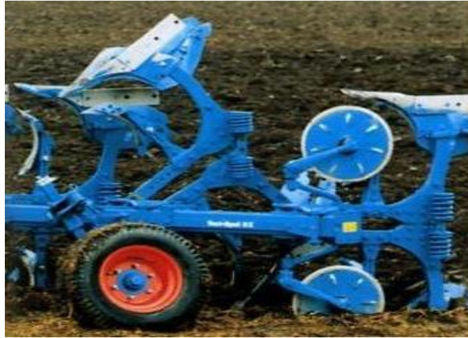
Obr. 10 Mechanické tandemové pružinové poistky ( http://pictures.tractorfan.nl/groot/1/lemken/2994-ploeg-lemken.jpg )
