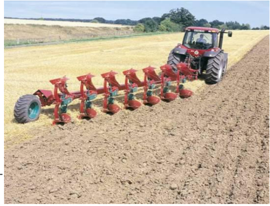
Obr. 7 Návesný pluh dočasne spojený s energetickým prostriedkom. A – Pracovná súprava na poli ( http://www.kverneland.cz/userdata/pictures/kverneland/priprava-pudy/pluhy/PB.jpg )
