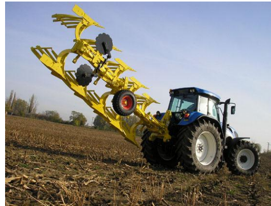
Obr. 6 Nesený pluh dočasne spojený s energetickým prostriedkom. A – Nesený pluh pri práci ( http://www.biso.sk/data/images/20081026132210PLUH_1b.jpg )
