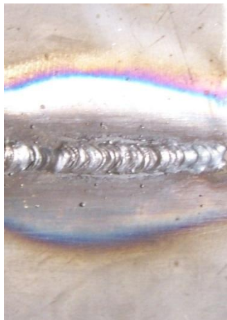
Obr. 18 [Zvar technológiou MMA elektródou E-R 117]
