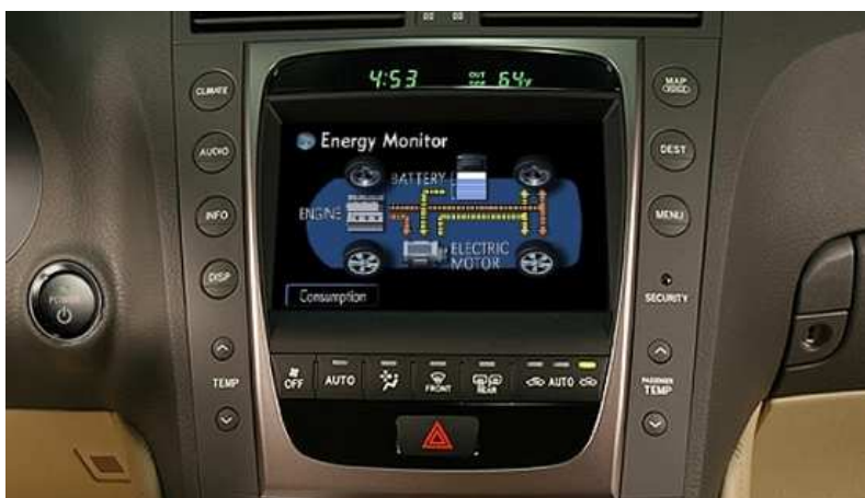
Obrázok 12: Schéma pretekania energie – Lexus
