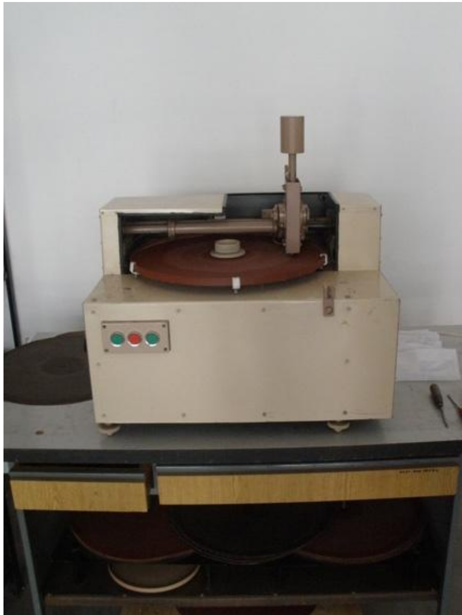
Laboratórne zariadenie s brúsnym plátnom na skúšky odolnosti proti abrazívnemu opotrebeniu podľa STN 01 5084
