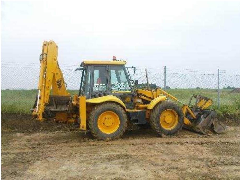
Obr. 13 Nasadenie kolesového rýpadlo nakladača JCB 4CX pri úprave terénu. (foto: Konc, 2010)
