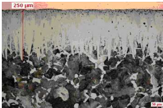
Obr. 12 Ocel 12 050, boridovaná 16 hodín pri teplote 900 °C
