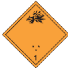
(Vzor 1) Podtriedy 1.1, 1.2 a 1.3 Symbol (explodujúca bomba): čierna na oranžovom podklade; číslica «1» v spodnom rohu
