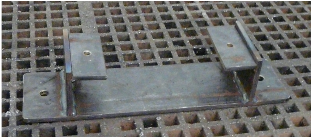
Obr. 20 Prípravok na prípravu vzoriek pre skúšku na brúsnom plátne bez šablóny
