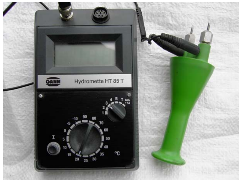
Obrázok 13 Vlhkomer Hydromette HT 85
