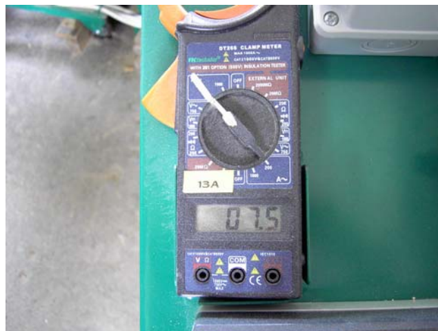
Obrázok 14 Meranie príkonu DT 266 CLAMP METER
