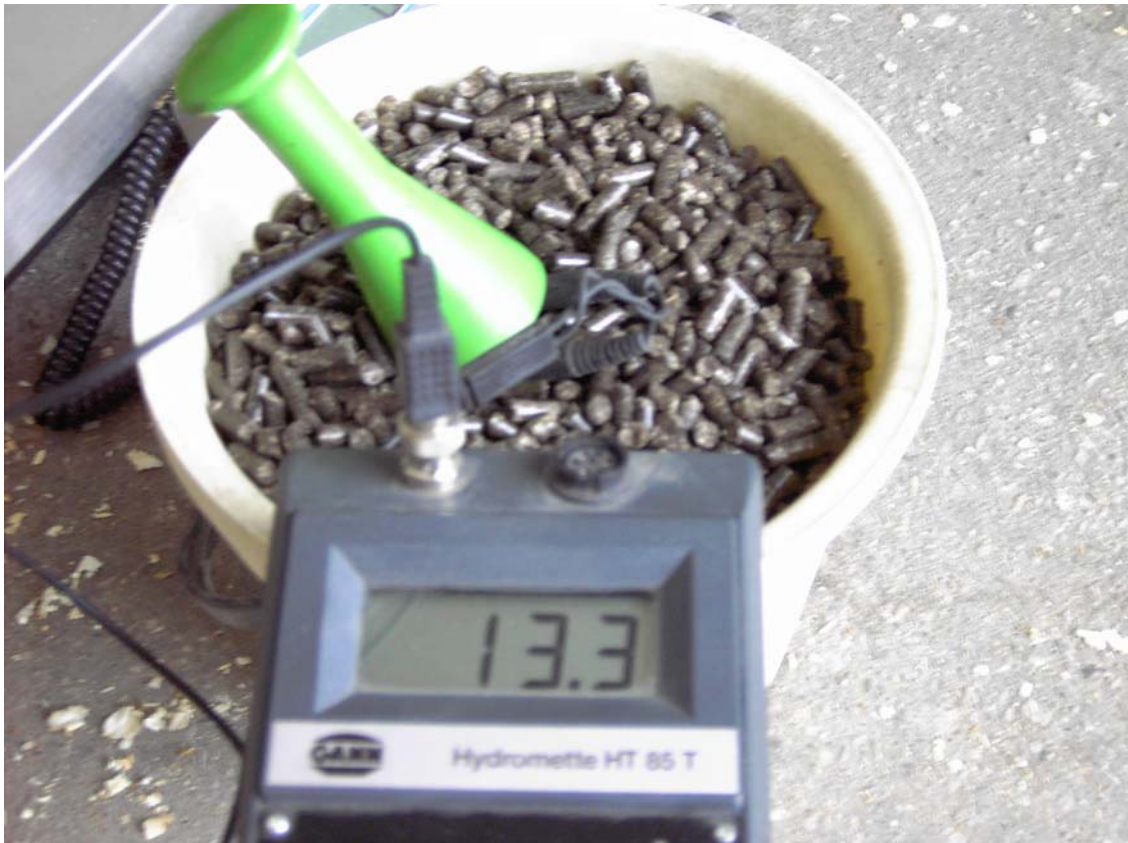
Obrázok 24 Meranie vlhkosti peliet zo zmesi č. 1 (pelety)
