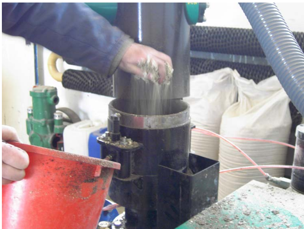
Obrázok 23 Dávkovanie zmesi priamo do peletizačného zariadenia.
