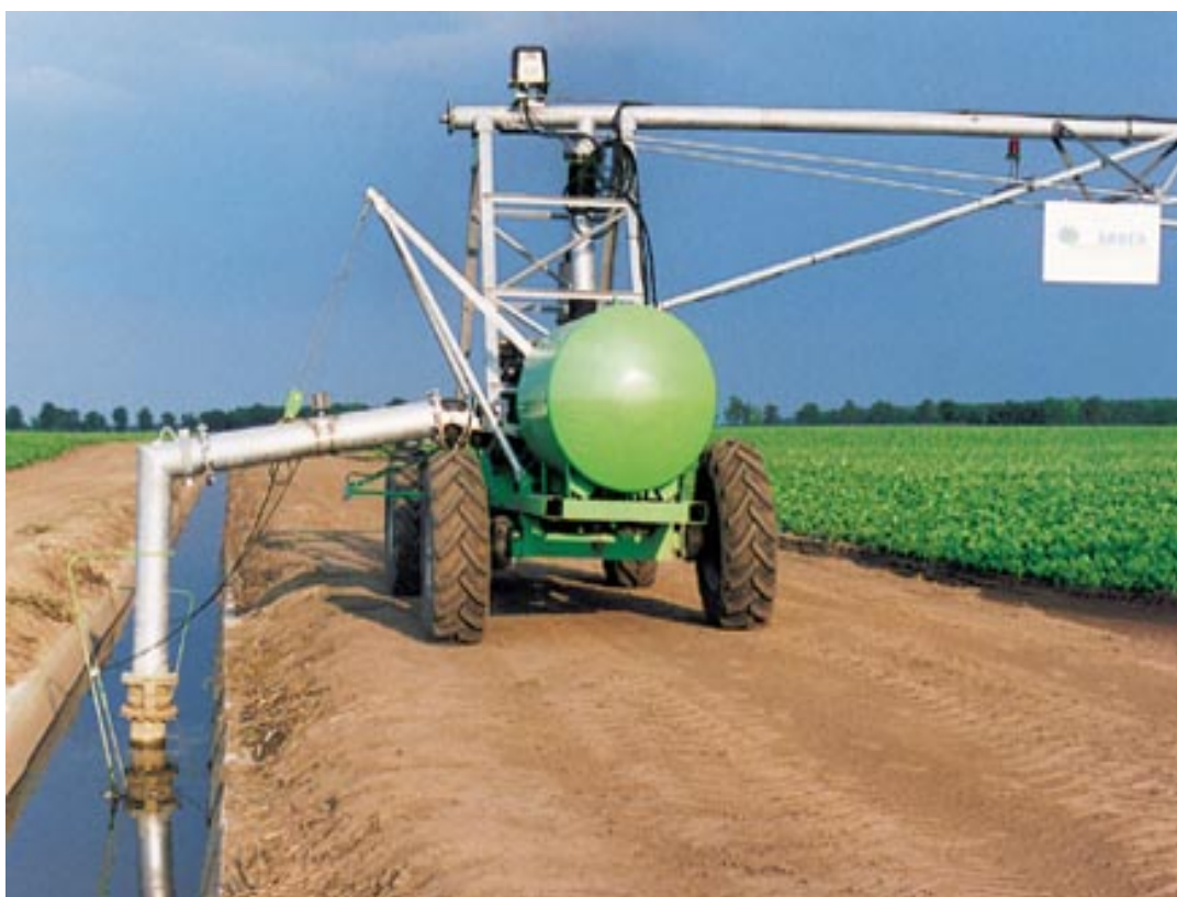
Obr. 17 Odber vody z kanálu, Bauer – Linestar 5000
