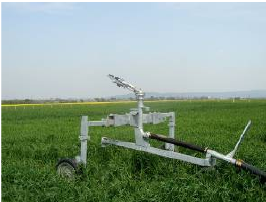
Obr. 8 Na podvozku je osadený sektorový ďalekoprádový postrekovač Komet TWIN 140,
