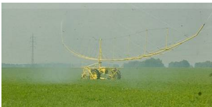
Obr.6 Schéma konzolového otáčavého zavlažovača 1-kolesový podvozok, 2-otočné konzoly, 3-postrekovače
