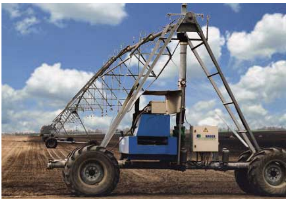
Obr.18 Frontálny širokozáberový zavlažovač s 4-kolesovou centrálnou jednotkou, s odberom vody z hydrantu, od firmy Bauer
