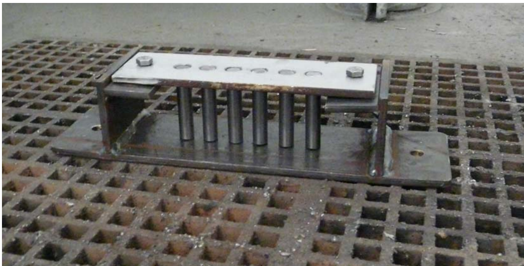
Obr. 15 Prípravok na naváranie vzoriek pre skúšku na brúsnom plátne
