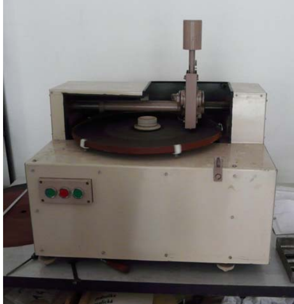
Obr. 18 Zariadenie na skúšanie odolnosti proti abrazívnemu opotrebeniu na brúsnom plátne
