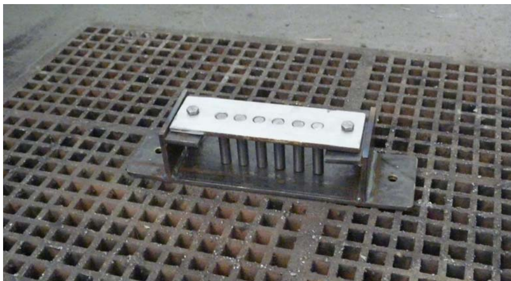
Obr. 7 Prípravok na naváranie vzoriek pre skúšku na brúsnom plátne
