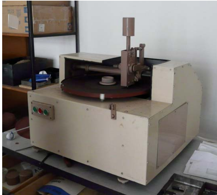
Obr. 8 Zariadenie na skúšanie odolnosti proti abrazívnemu opotrebeniu na brúsnom plátne
