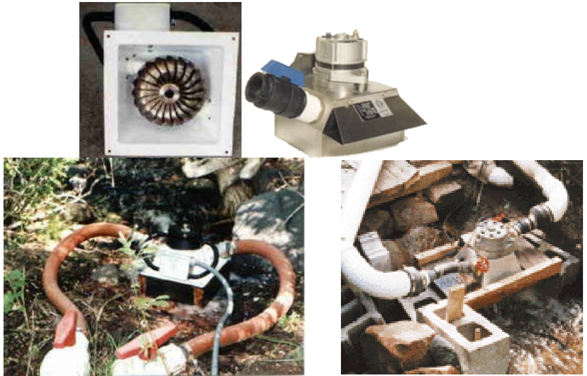
Obr. 12 Príklady zapojenia mikroelektrárne v praxi (Zdroj:www.zdruzeniepcola.org)
