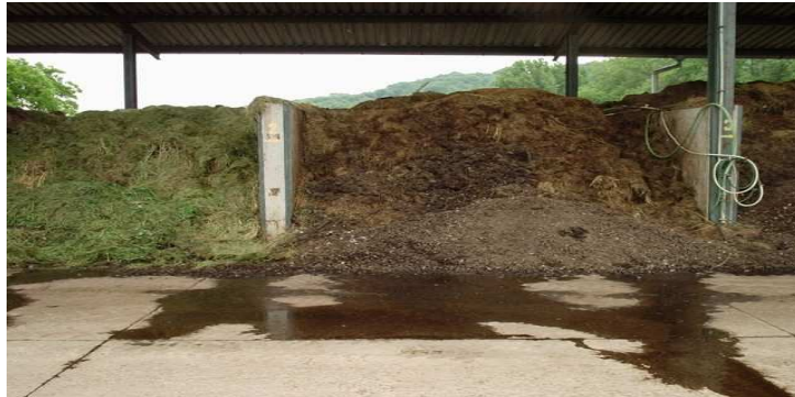
Obr. 21 Otvorená boxová kompostáreň s nútenou aeráciou (Galovič, 2007)
