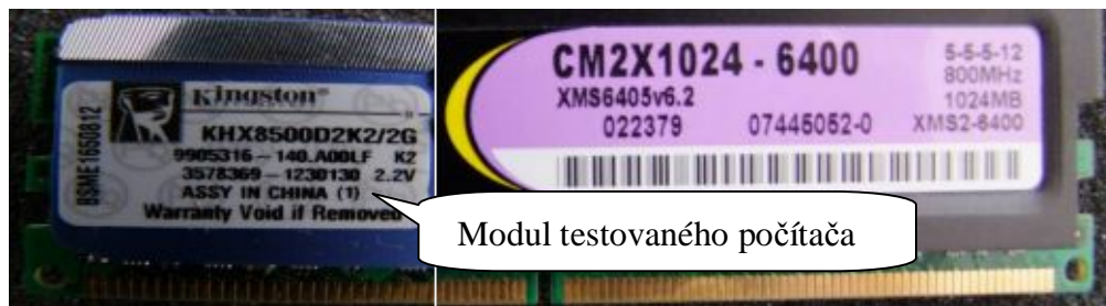
Obr.25 Príklady označenia RAM modulov operačnej pamäte.
