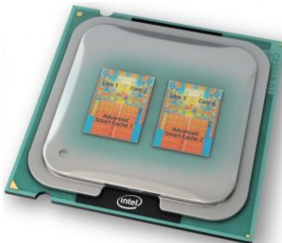
Obr. 2 Umiestnenie a tvar čipov Quad Core v procesore Intel ( Intel, 2009 )
