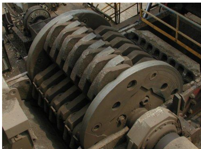
Obr. 4 Rotor po zošrotovaní 1,6 milióna ton kovového materiálu
