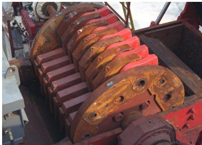
Obr. 3 The Wendt heavy shredder - nový rotor pred drvením.
