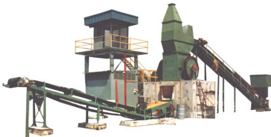
Obr. 1 Drvič (shredder) na spracovanie starých kovov
