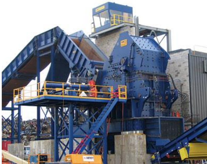
Obr. 2 Drvič starých automobilov „The Wendt Heavy Shredder“
