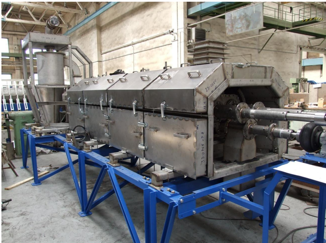
Obr. 17 Zariadenie na pyrolýzne spracovanie odpadov PYROMATIC ( http://www.strobo.cz/editor.php?kategorie=1023&sekce=1008 )
