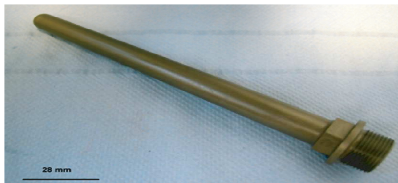
Obr. 10 Sklársky trň vyrobený z ocele X210Cr12
