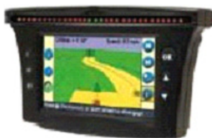
Monitor navigačného prístroja so svetelnou lištou AgLeader EZ-Guide 500
