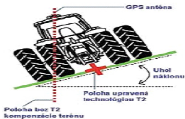
Princíp kompenzovania svahovitosti terénu pomocou technológie T2
