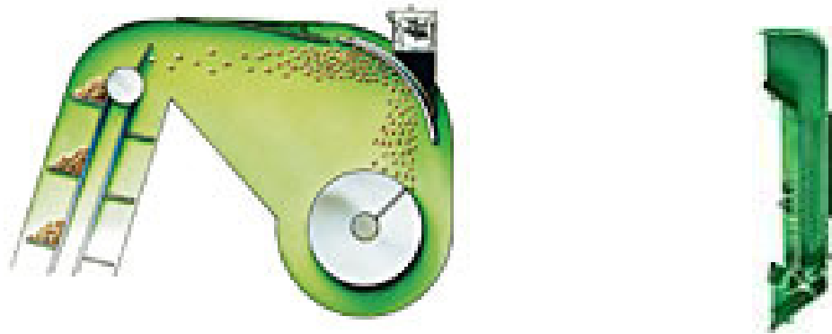
Obrázok 21 - Snímač hmotnostného toku zrna a snímač vlhkosti
