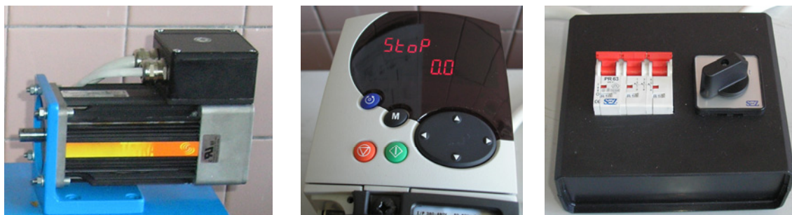
Obrázok 17 Krokový motor TETRA 2.2 (vľavo), frekvenčný menič UNIDRIVE SP 1402 (v strede) a plastový rozvádzač - istenie motora (vpravo)
