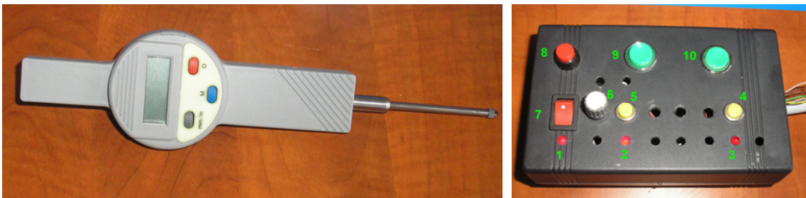
Obrázok 19 Odchylkomer TIGRA 0.01-50 (vľavo) a ovládací panel zväračky (vpravo)
