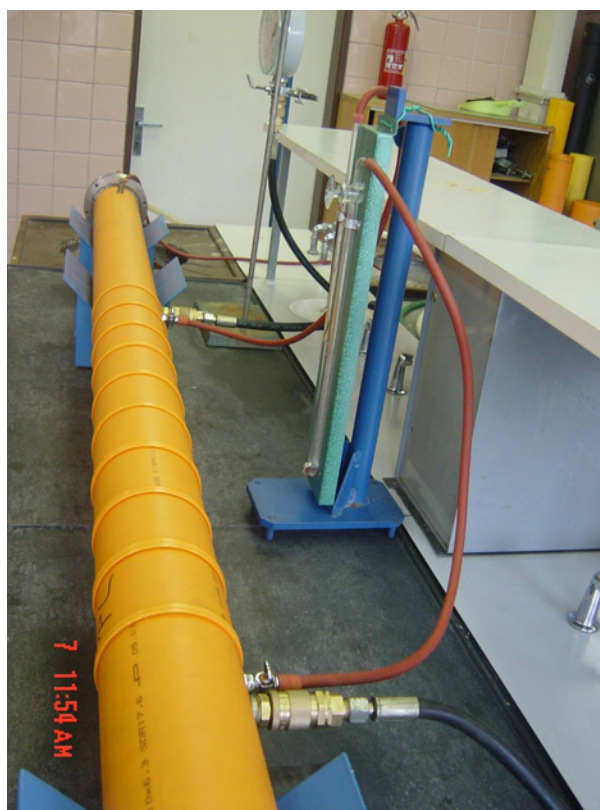
Obrázok 24 Meracia sústava slúžiaca na predbežné merania tlakových strát realizovaná vo VÚSAPLi
