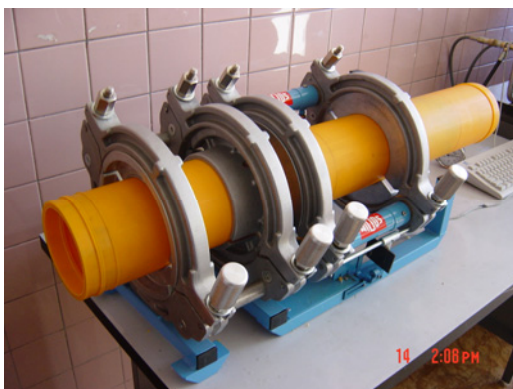
Obrázok 10 Umiestnenie zváraných rúr v čelustiach zväračky WIDOS 4600
