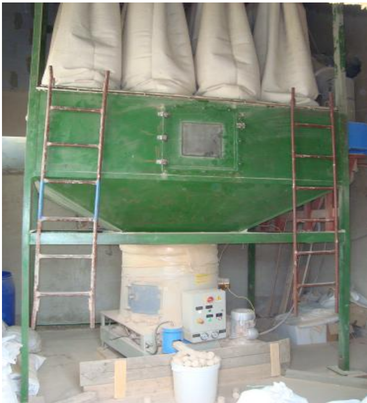
Obr.21 Lis na výrobu briekiet s výkonom 80 kg.h -1 vo firme Drevar Dolné Obdokovce
