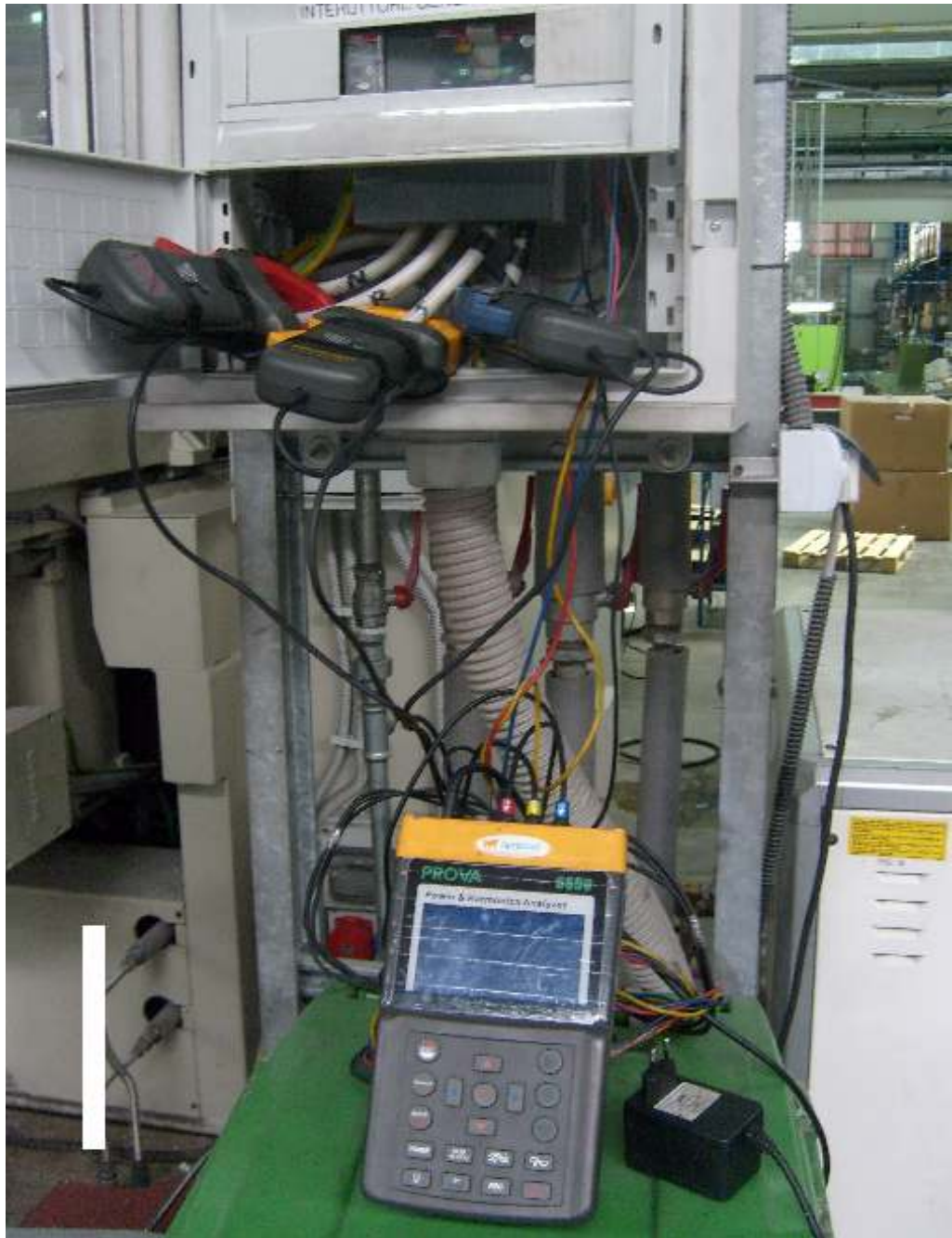
Obr. 8. Príklad zapojenia meracieho prístroja Prova 6800.
