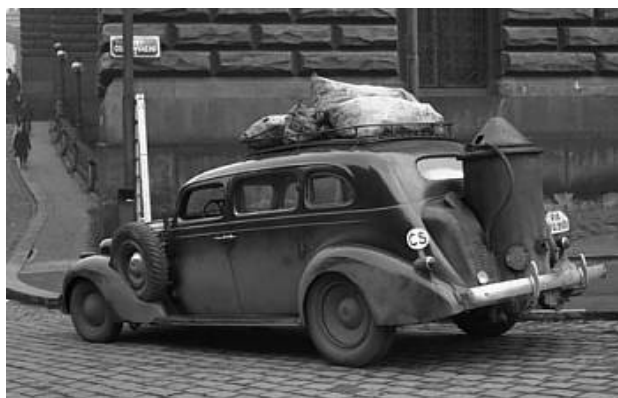
Obrázok 4 Motorové vozidlo so splynovacím agregátom
