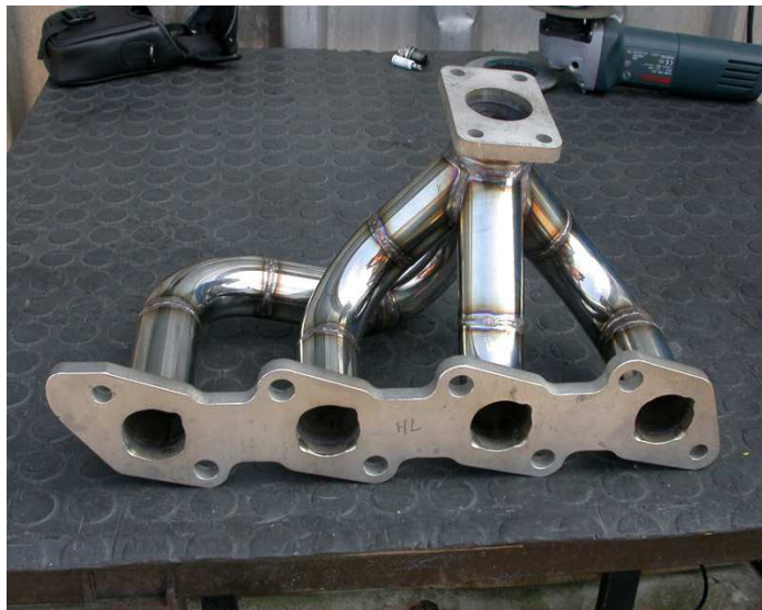
Obr. 5 Výfukové zberné potrubie
