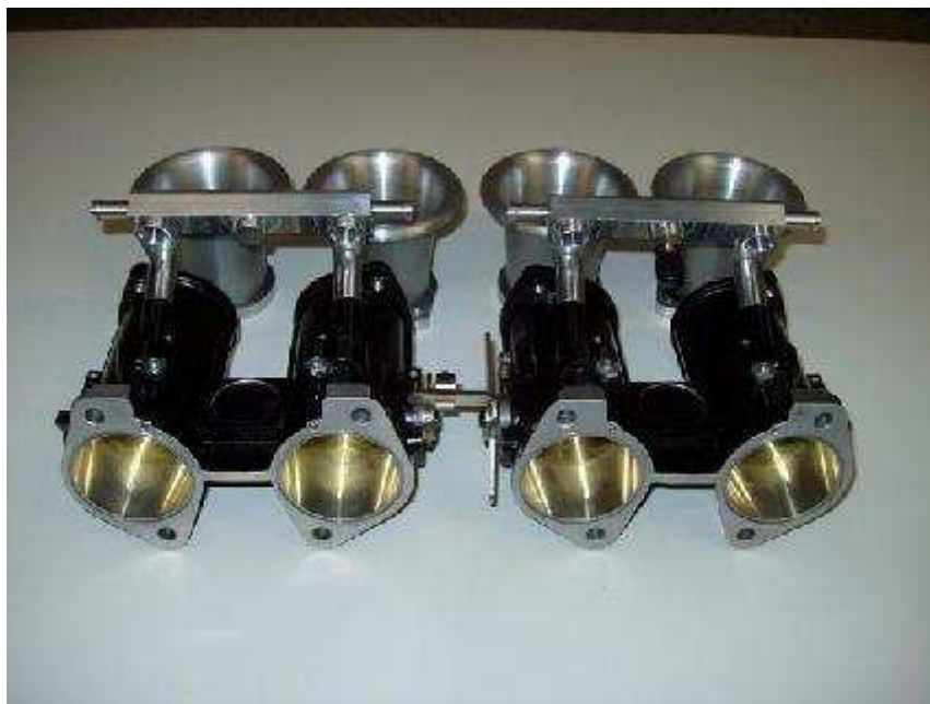
Obr. 6 Nasávacie potrubie so vstrekovacou rampou
