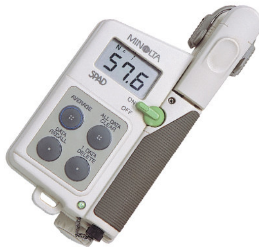
Obrázok 3. Chlorofylmeter SPAD-502 pre nedeštrukčné meranie obsahu chlorofylov.
