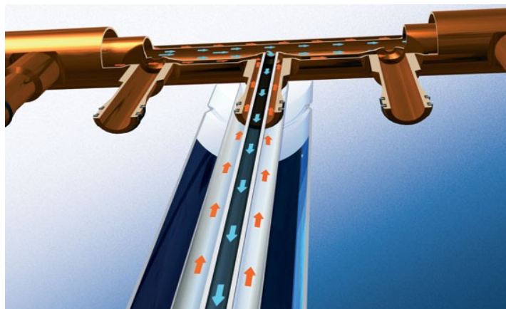
Obr.4 Konštrukcia vákuového trubicového kolektora priamoprietočne.
