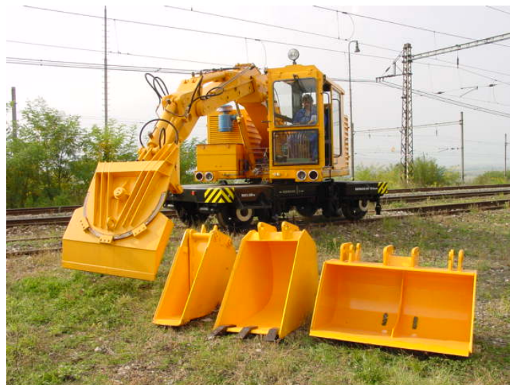
Obr. 5 Železničný zemný stroj ŽZS-026(MTH REMONT, 2010)
