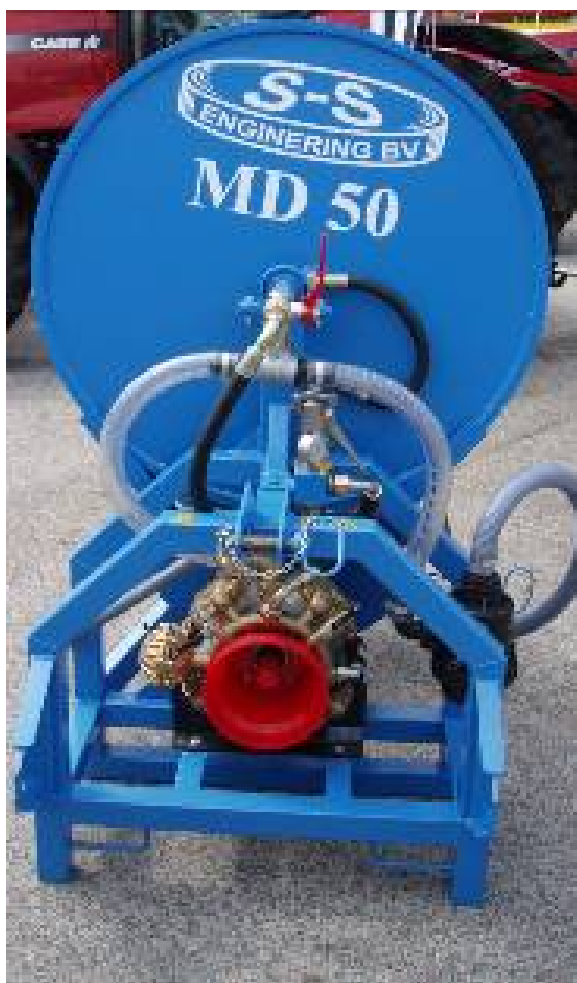
Obr. 12 Drenážny hydročistič MD- 50 (MD – 50, 2010)
