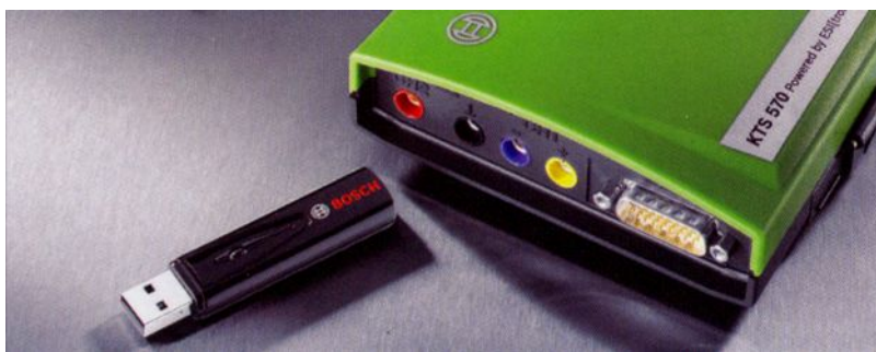
Obr. č. 4: Diagnostický tester BOSCH KTS 570 (zdroj: Diagnostika Bosh pro současnost i budoucnost autoservisu, 2007).
