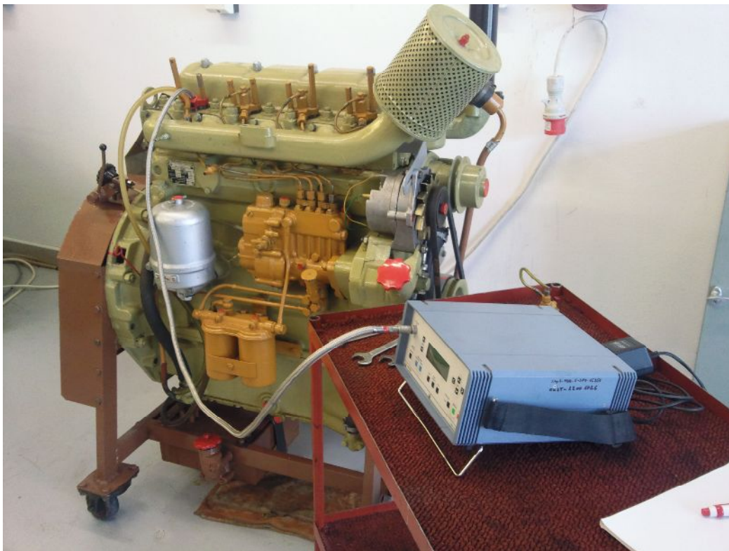
Obr. A.10: Záznamová jednotka KISTLER 2507 A a jej zapojenie na Motor ZETOR 8401.
