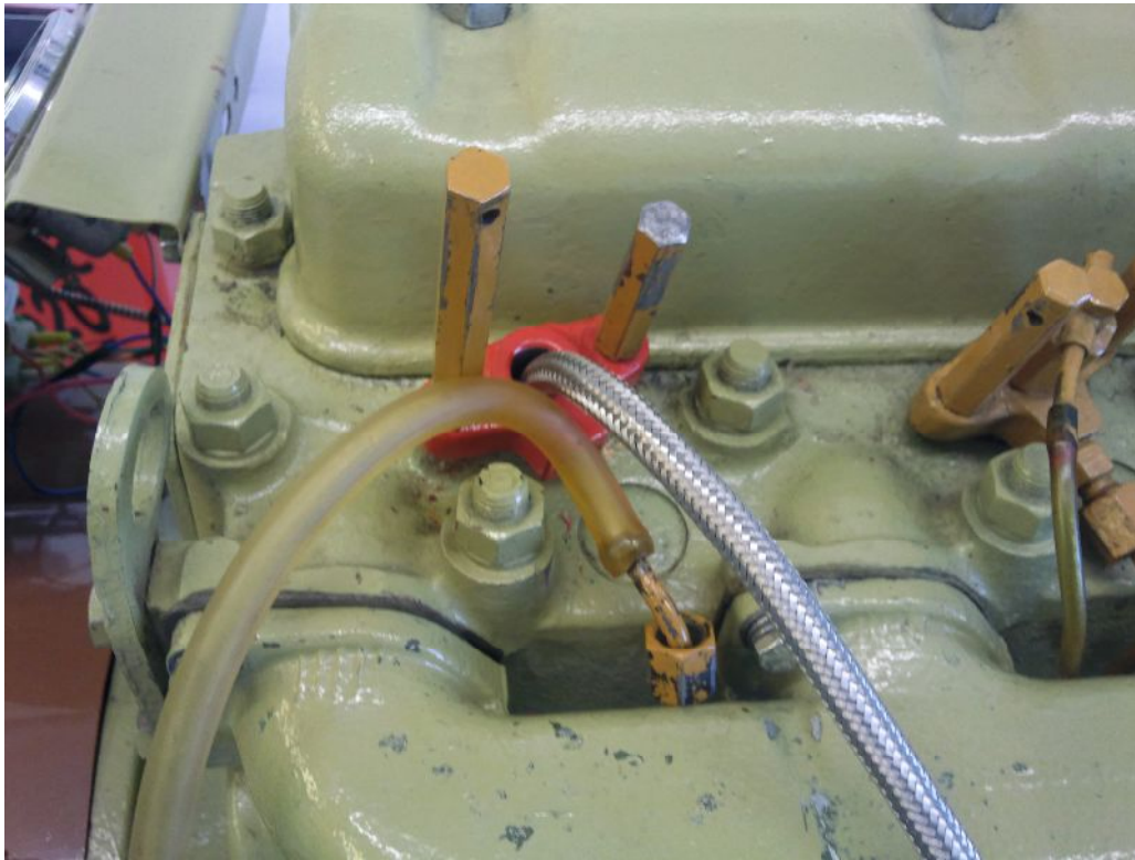
Obr. A.9: Montáž adaptéra s piezoelektrickým snímačom.
