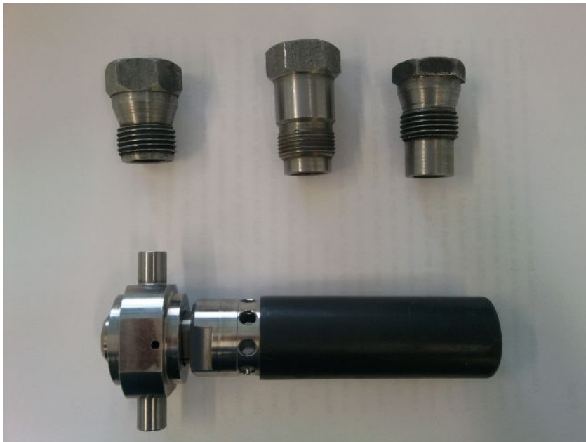
Obr. č. 17: Adaptér pre lodné vznetrové motory a nadstavce.
