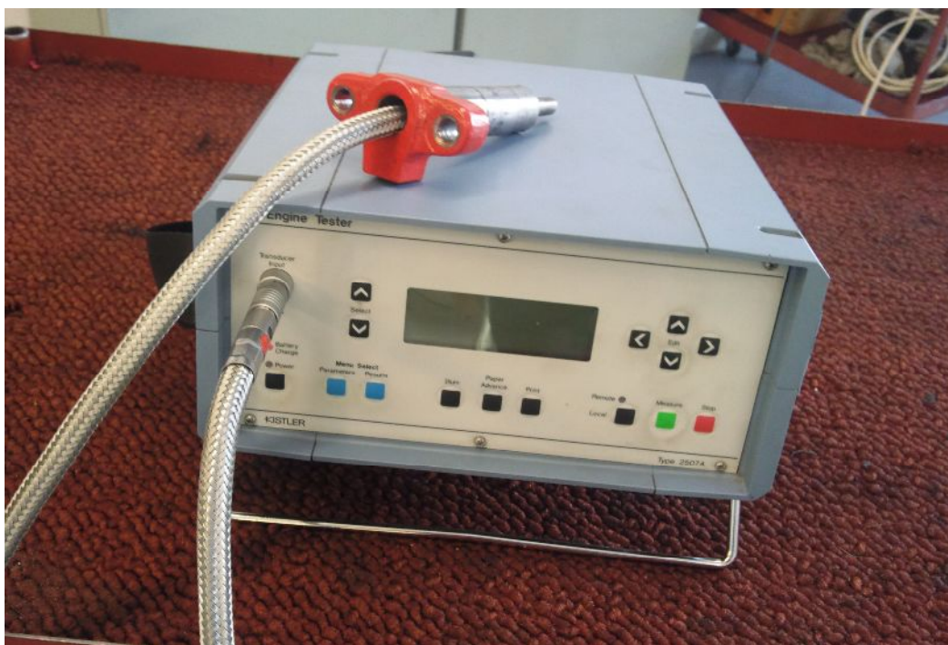
Obr. A.3: Predná časť záznamovej jednotky KISTLER 2507 A a adaptér s piezoelektrickým snímačom.
