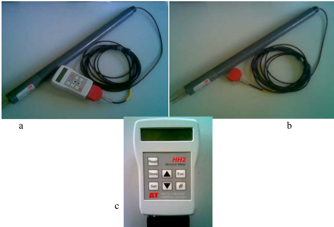
Obr. 7 Prístroj ThetaProbe (ML2x) s čítacou jednotkou HH2 a) ML2x s HH2 loggerom, b) ThetaProbe (ML2x), c) HH2 logger
