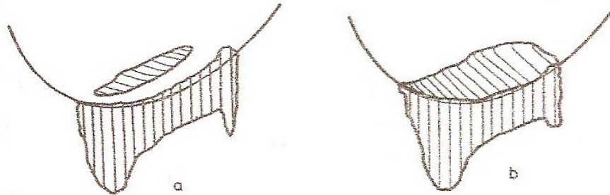
Obr. 8 Typické opotrebenie rezného klina pri obrábaní (Békés, 1981)
