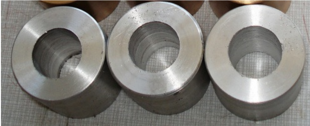
Obr. 22 Vyvrtané vzorky - dural
