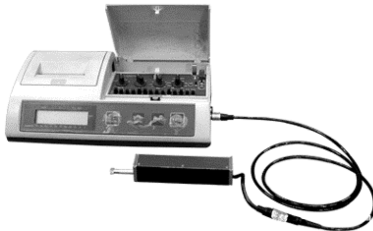
Obr. 21 Merací prístroj Mitutoyo Surftest 301 (ILJIN, 2003)
