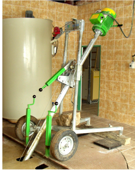
Obr.7 Propelerové miešadlo na úpravu vstupného substrátu.
