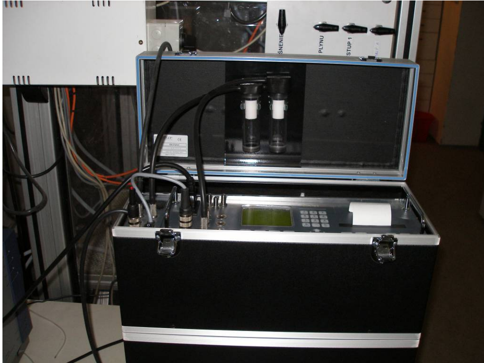
Obr.22 Meranie analyzátorom bioplynu MADUR.
