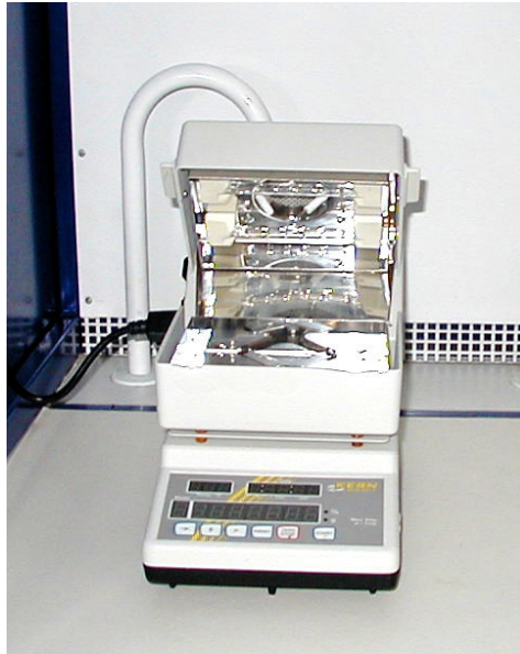
Obr.14 Sušínové váhy KERN MLB 50-3.
