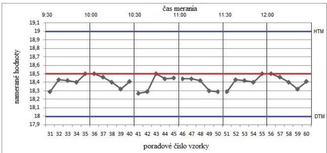
Graf 2: Grafické zobrazenie nameraných hodnôt dĺžky slugu na 5 vzorkách v 30 minútových intervaloch umiestnených do HTM a DTM
