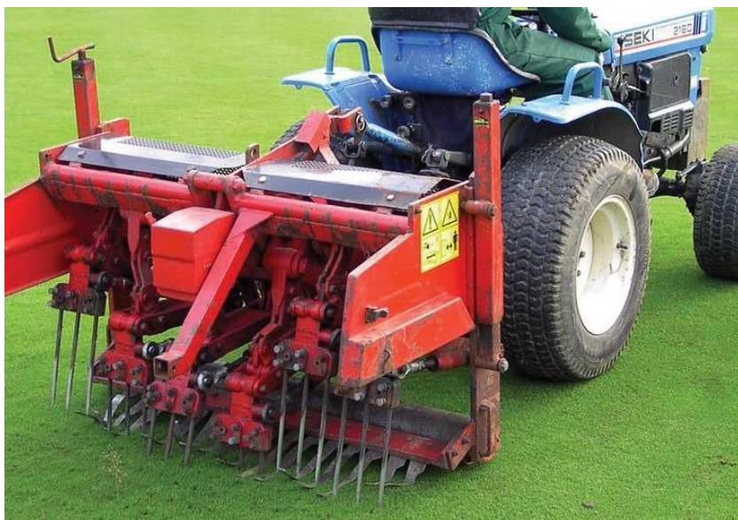
Obr. 7: Aerifikácia plnými hrotmi (Zdroj: www.verti-drain.com )
