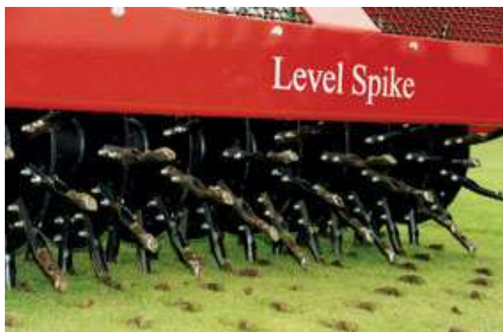
Obr. 8: Aerifikácia dutými hrotmi (zdroj: www.kvetyzahrada.sk )
