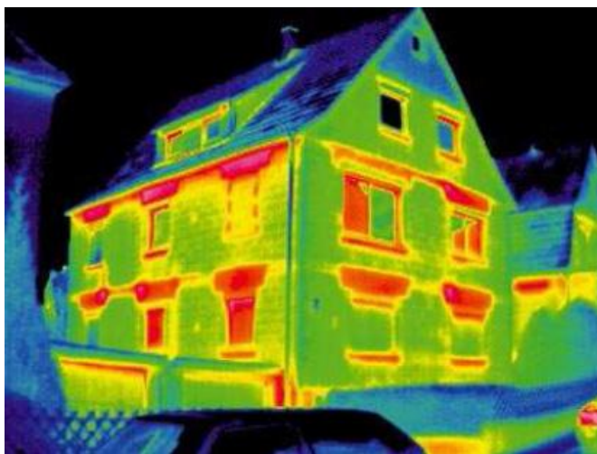
Obrázok 01: Ukážka termovíznej snímky znázorňujúcej tepelné mosty na budove
