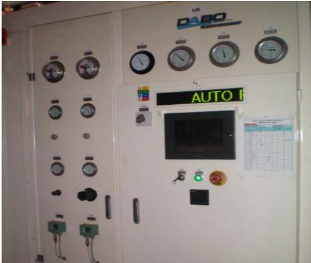
Obrázok 1 Automatický vstrekovací lis – ovládací panel
