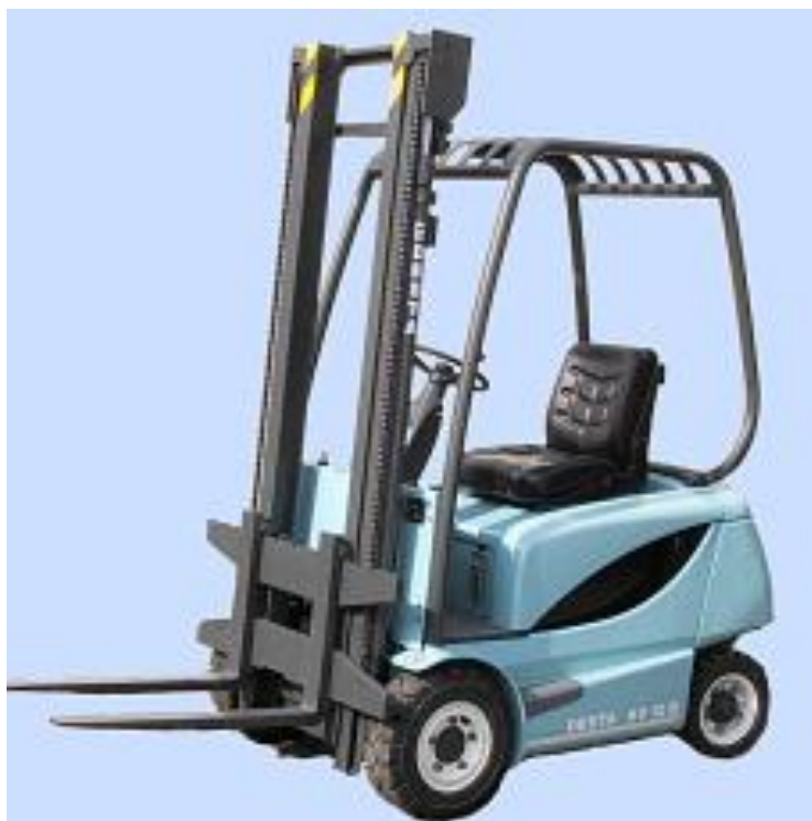
Obr. 3 Akumulátorový vysokozdvížný vozík
