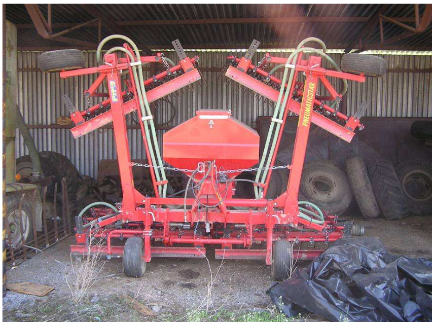
Obr. 27, 28: Sejačka na prísev do trávnych porastov PneuStar Einbäck – záber 6 m (Blichá, 2010)
