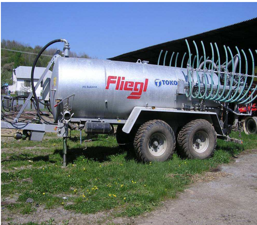
Obr. 32: Cisterna na aplikáciu hnojovice s rezacím ústrojenstvom a hadicovým aplikátorom Fliegl (Blichá, 2010)
