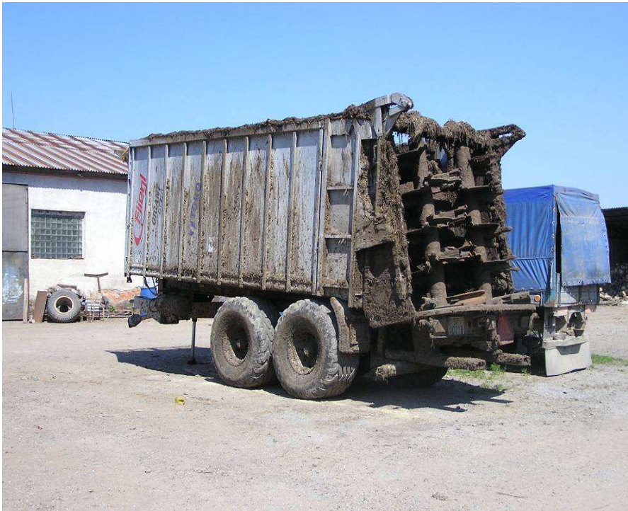
Obr. 31: Veľkokapacitné rozmetadlo maštalného hnoja vhodné na hnojenie trávnych porastov Fliegl (Blichá, 2010)
