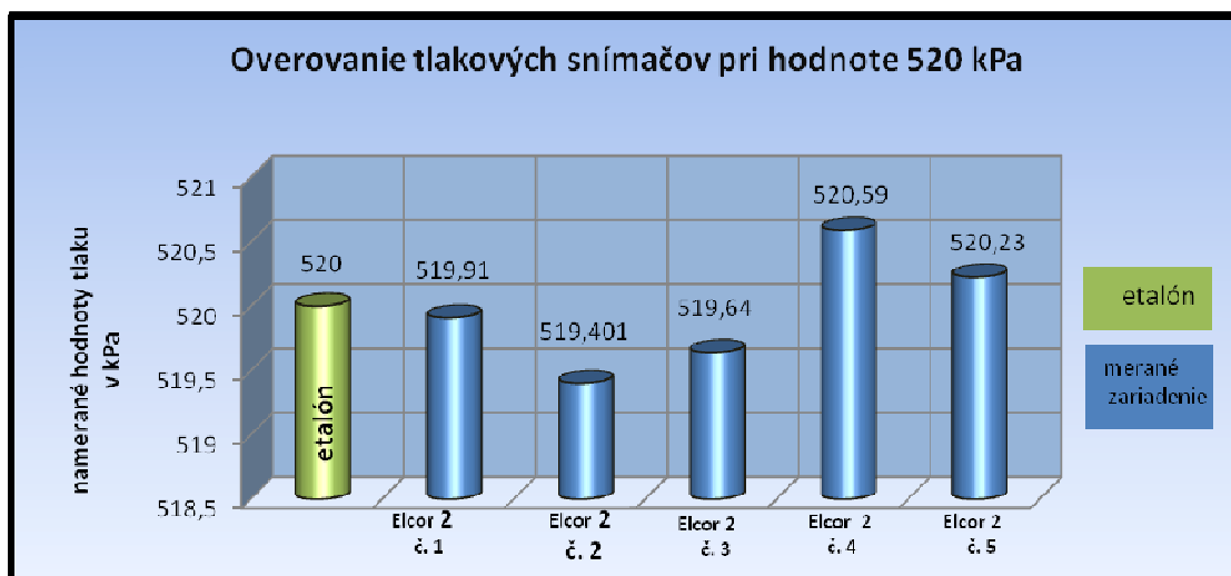
Graf č. 23 Overovanie tlakových snímačov pri hodnote 520 kPa
