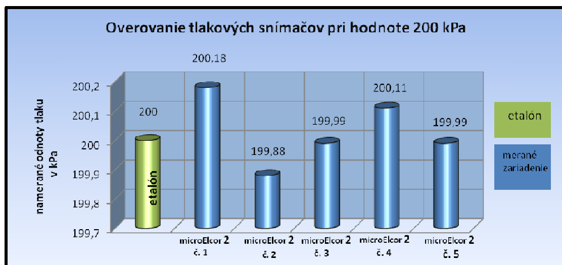
Graf č. 12 Overovanie tlakových snímačov pri hodnote 200 kPa
