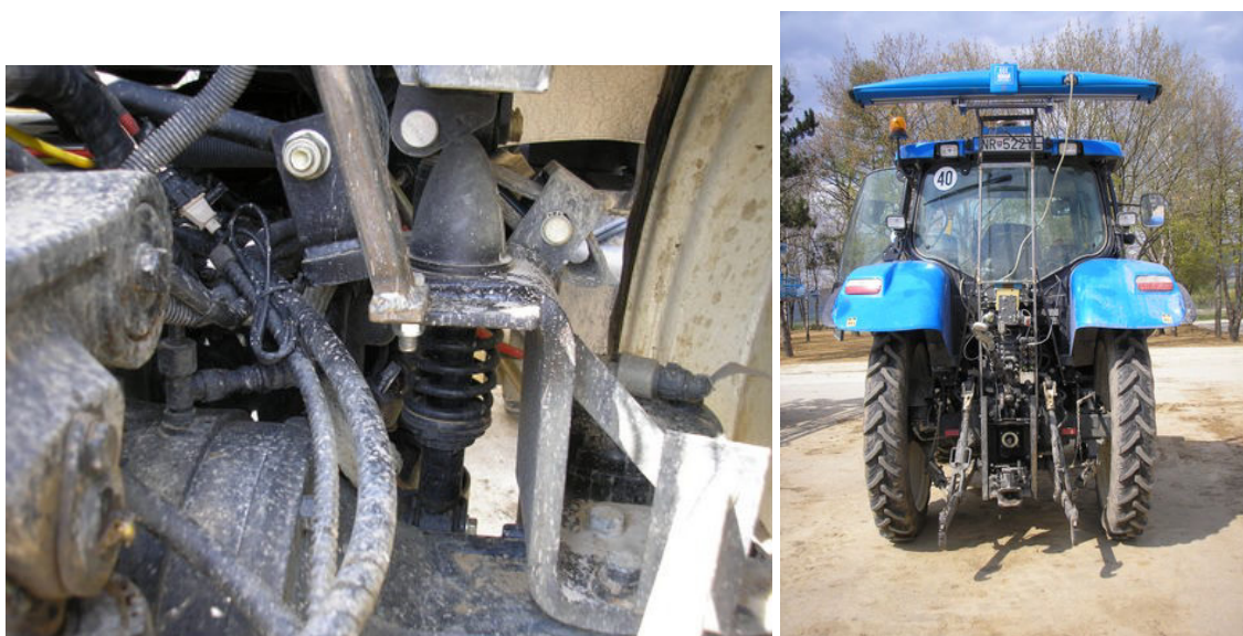
Obrázok 4-5 Rámový držiak prijímacej antény a N-Senzora uchytený o pevnú časť rámu
