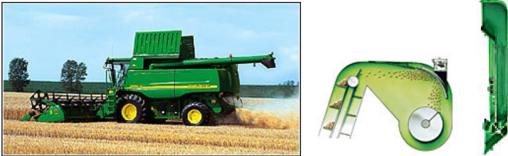
Obrázok 1-8 Systém monitorovania úrody, snímač hmotnostného toku zrna a snímač vlhkosti zrna od John Deere (2011)
