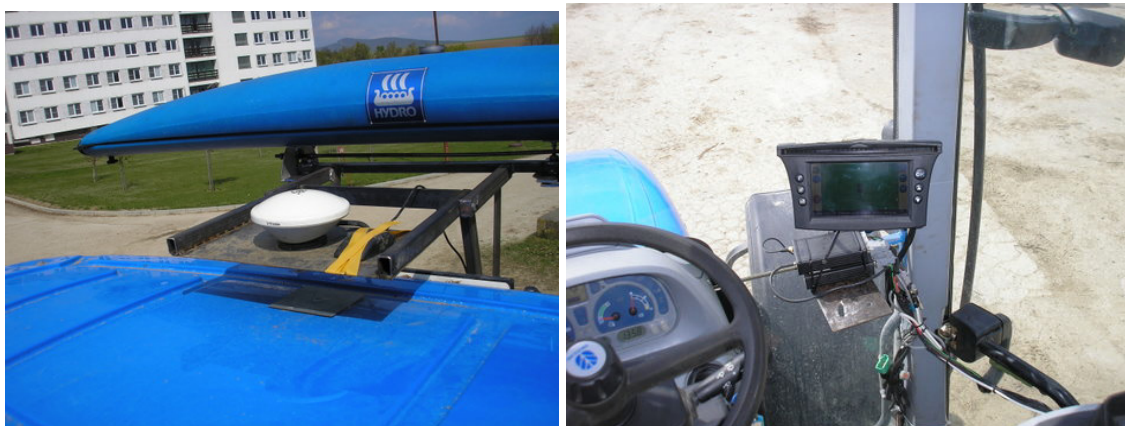
Obrázok 4-4 Umiestnenie antény na pevný rám a navigačný display v kabíne traktora
