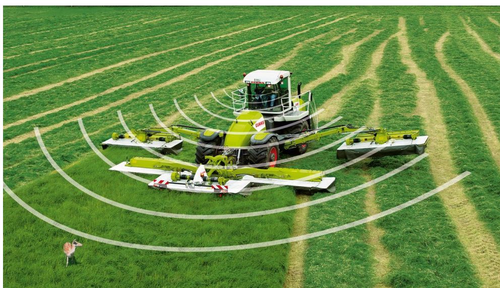
Obr. 13 Systém ochrany zvierat. (www.agromachinery.cz)
