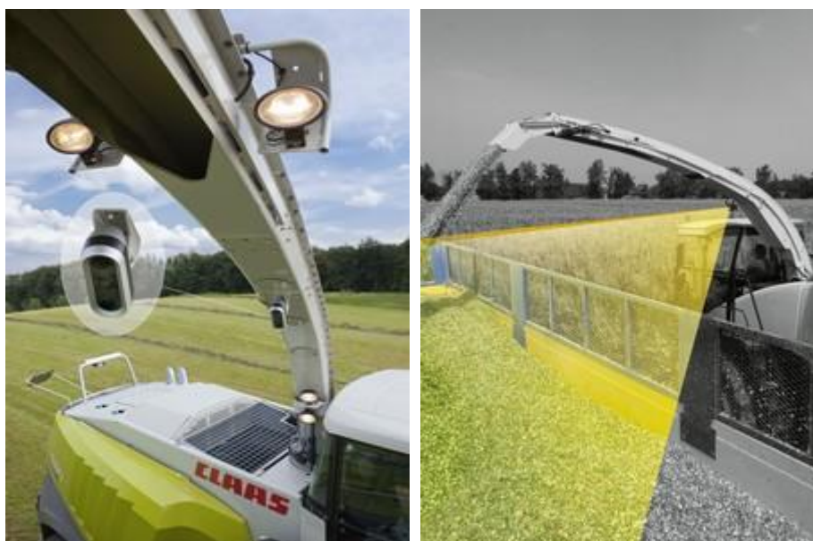
Obr. 14 Systém plnenia dopravných prostriedkov. ( www.agromachinery.cz )
