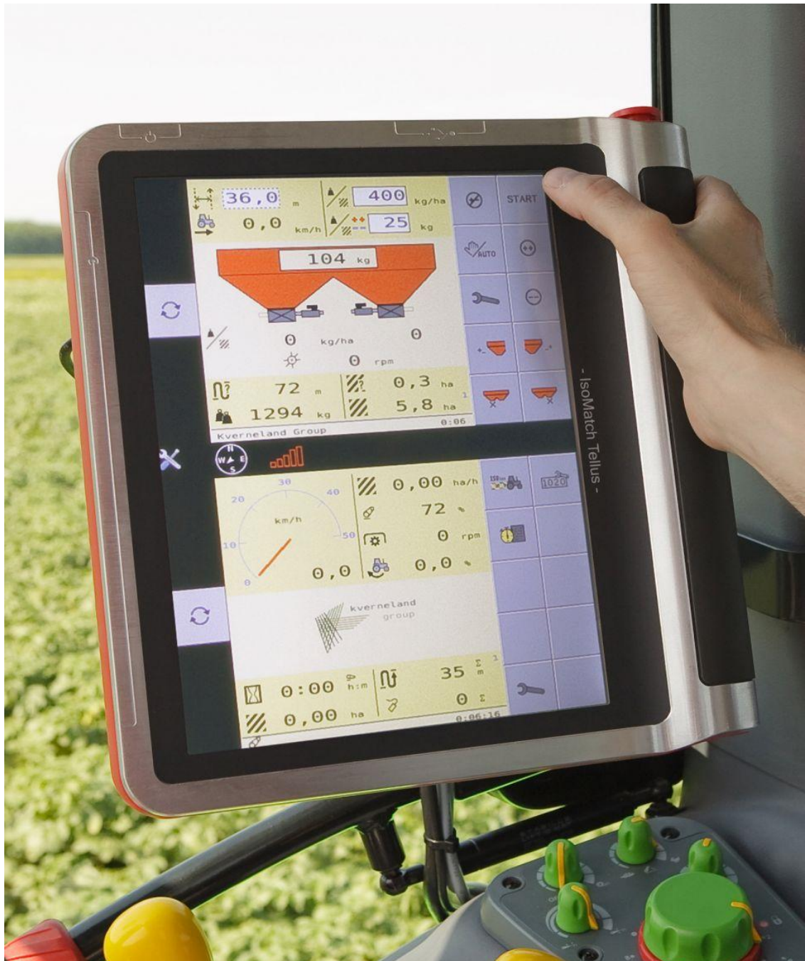
Obr. 10 Konzola na ovládanie dvoch ISOBUS kompatibilných strojov. (www.agromachinery.cz)
