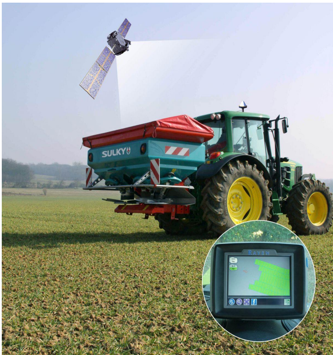
Obr. 8 Rozmetadlo na priemyselné hnojivá s automatickým regulovaním. (www.agromachinery.cz)
