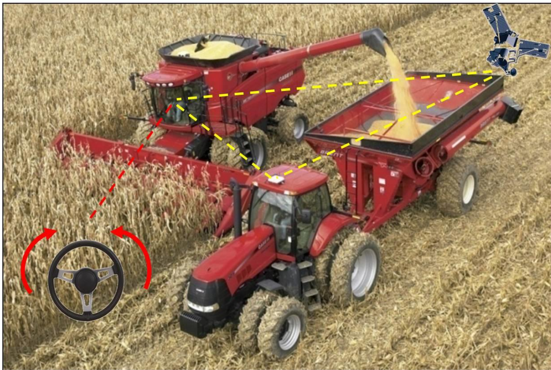
Obr. 4 Systřm dřřkovřho riadenia dvoch strojov. ( www.agromachinery.cz )
