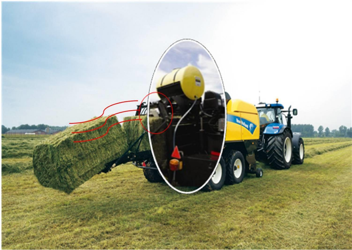
Obr. 11 Lis New Holland so systémom na označovanie balíkov. (www.agromachinery.cz)
