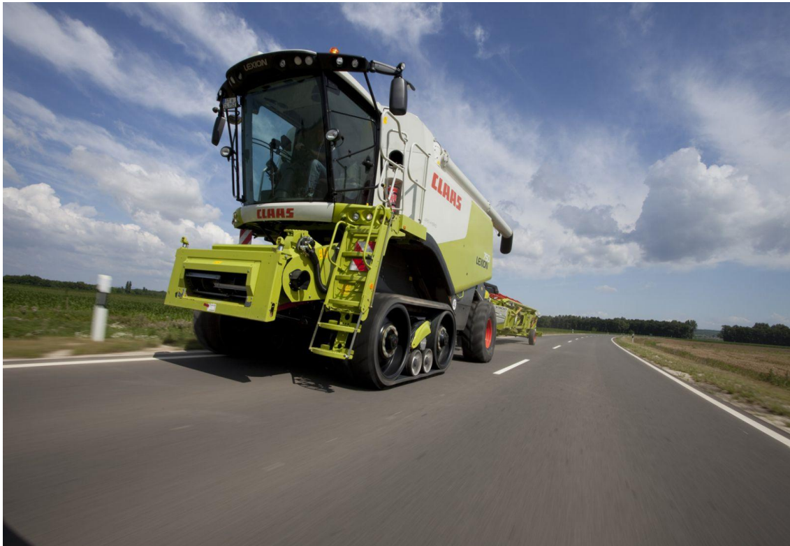
Obr. 9 Claas Lexion s odpruženým pásovým podvozkom. (www.agromachinery.cz)
