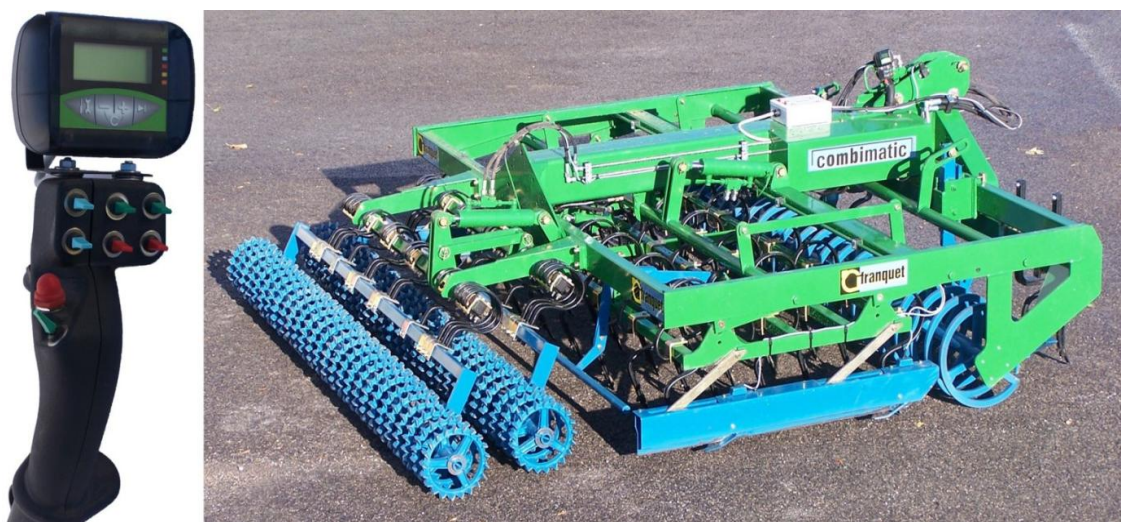
Obr. 7 Náradie na prípravu osivového lôžka s elektronickým ovládaním. ( www.agromachinery.cz )
