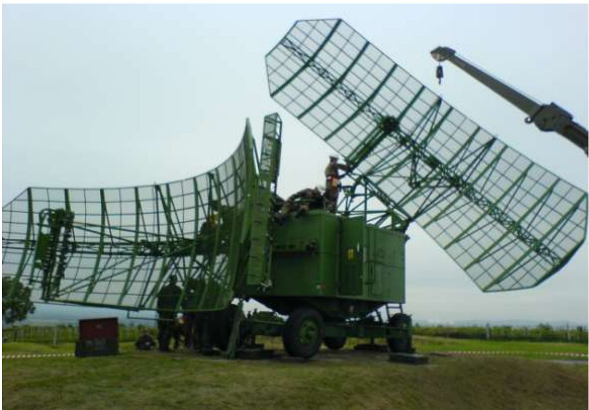
Obr. 6 [Montovanie horného reflektora. Rádiolokátor P – 37MSK] (14)
