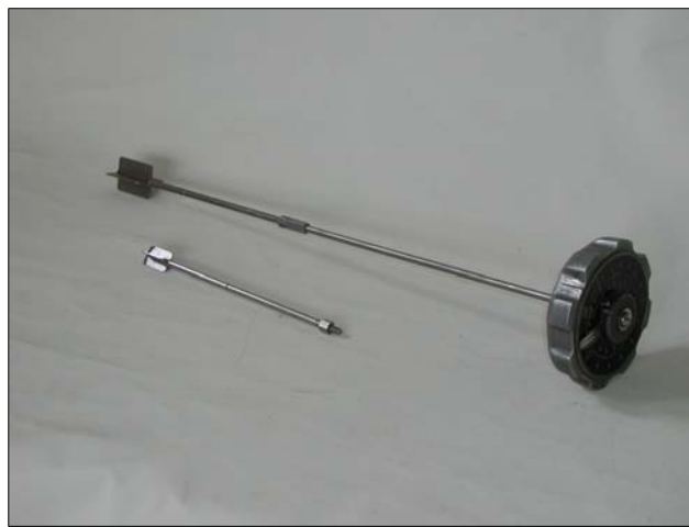
Obr. 13 Ručný vrtuľkový prístroj typu PILCON – EDECO na zisťovanie šmykového odporu pôdy
