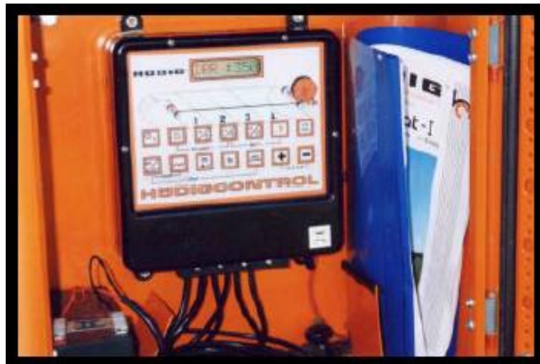
Obr. 9 Riadiaci systém k variabilnému nastaveniu rýchlosti Irrigamatic 350 (Al-Karadsheh, Sourell, Sommer, 2003, s.106)
