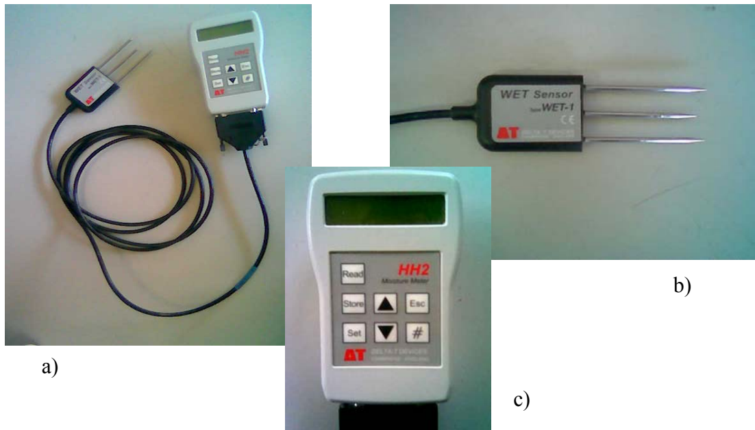
Obr. 12 WET senzor s HH2 čítačou jednotkou a) WET senzor s HH 2 loggerom, b) WET senzor, C) HH2 logger
