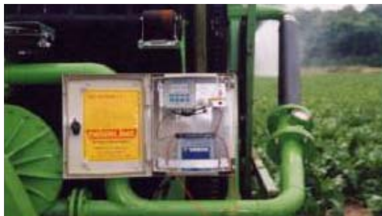
Obr. 10 Variabilné nastavenie rýchlosti so systémom Rain (Al-Karadsheh, Sourell, Sommer, 2003, s.107)
