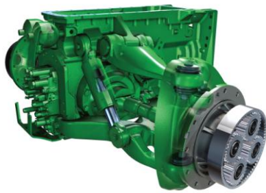
Obr.32 Odpružená predná náprava traktora John Deere
