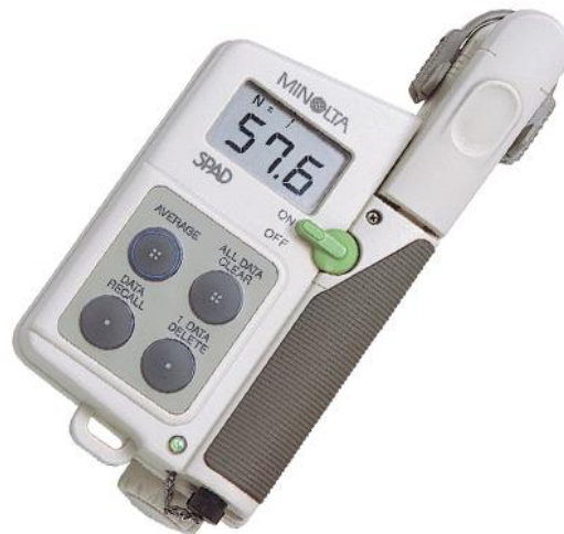
Obr. 1. Použitý prístroj pre nepriame meranie obsahu asimilačných pigmentov – SPAD-502 (Minolta, Japonsko).
