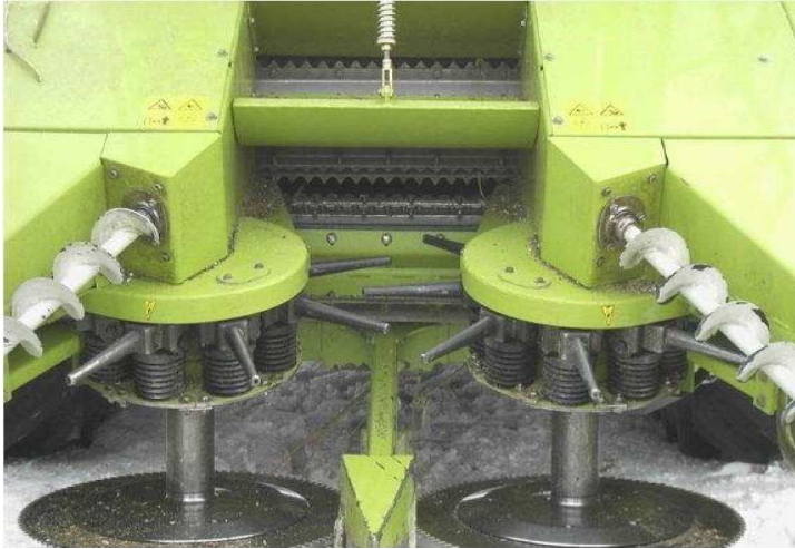
Obr. č. 4 - Rezací systém žaťevného kombajnu (BioSalix Energy s.r.o)
