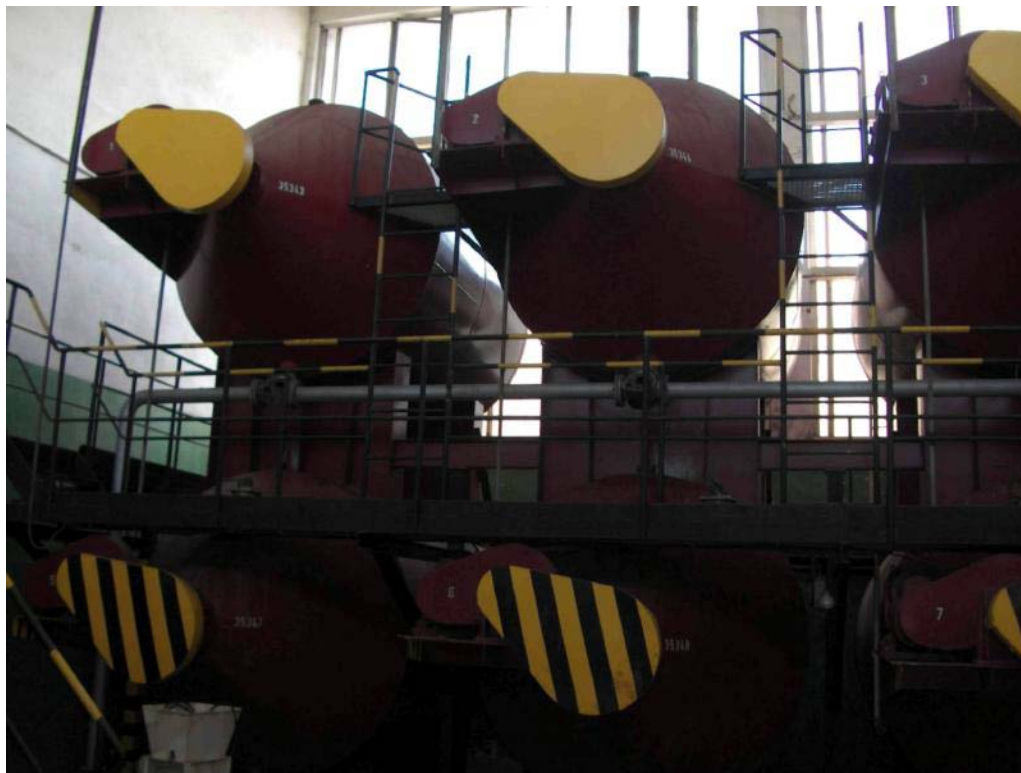
Obrázok 3 F: Pohľad na rotujúce nádrže na vylúhovanie farbiva a alkoholové kvasenie
