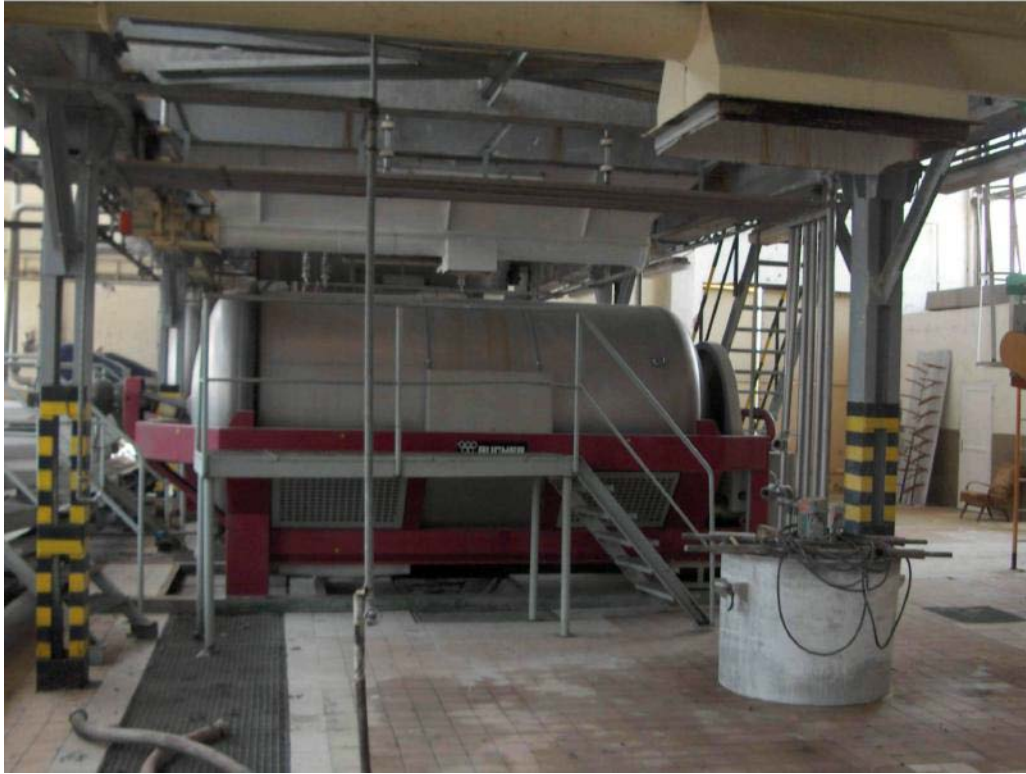
Obrázok 3 E: Bočný pohľad na pneumatický lis Vaslin – Bucher RPA 100
