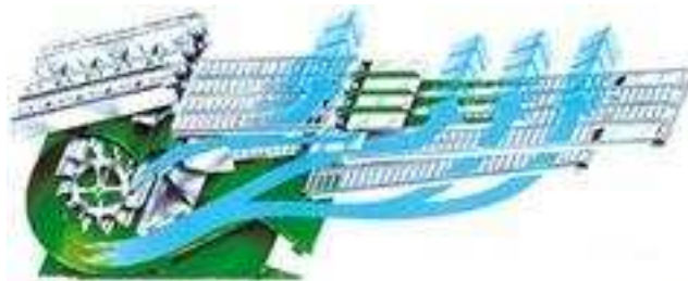
Obr. 2-20 Trojstupňové čistenie so závitovkovými dopravníkmi (John Deere S690i)
