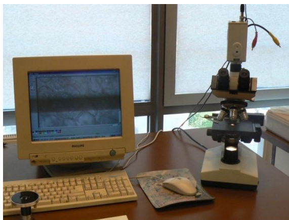
Obr. 16 Experimentálne zariadenie (počítačová zostava, mikroskop, CCD kamera)
